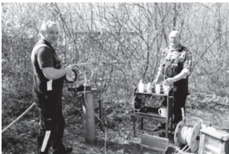
Überprüfung direkt vor Ort: Das Rohwasser wird von Peter Schröder und Uwe Zischke (v.r.) auf festgelegte Parameter wie pH-Wert, Leitfähigkeit, Temperatur und Sauerstoffgehalt untersucht.
