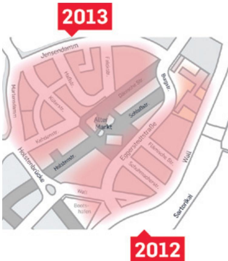
**Dampfnetzumstellung:** Bereits seit April werden insgesamt 140 Immobilien westlich des Alten Marktes auf die zukunftsweisende Heizwassertechnologie umgestellt. Bis Ende September sind diese Bauarbeiten abgeschlossen, und es geht dann im Frühjahr 2013 mit den Arbeiten östlich des Marktes weiter.
