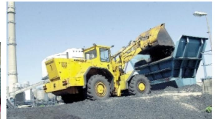
Futter fürs Kraftwerk: Ein Rad-Lader trägt den Steinkohle-Berg ab.
