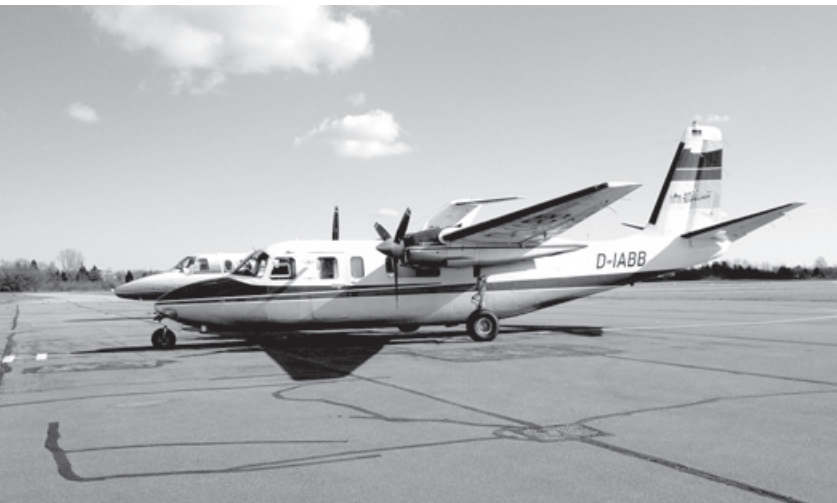
Nachtflug: Bis in den frühen Morgen kreiste die zweimotorige Propellermaschine über Kiel, um Wärmeverluste im Fernwärmenetz aufzuspüren.
