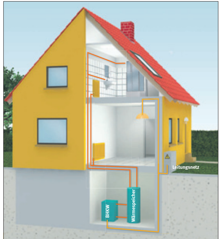
Mikro-Blockheizkraftwerke für den Keller: Die kleinen Anlagen sind nicht größer als eine Spülmaschine und für Privathaushalte geeignet.
